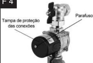
Solte o parafuso e retire a tampa de proteção das conexões.
