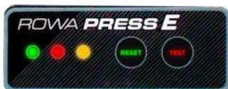
**D.9) Inicialização:** Ao conectar o equipamento à rede elétrica, ele ligará automaticamente e iniciará a leitura da pressão da rede, mantendo as três luzes acesas por cerca de 40 segundos. Em seguida, o equipamento entrará em modo de espera até detectar consumo, momento em que o LED verde piscante permanecerá aceso continuamente, indicando o funcionamento.
