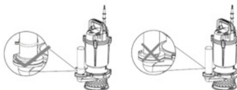
4.5 - Fica estritamente proibido puxar o cabo elétrico, enrola-lo ou utiliza-lo como cabo de içamento, durante a operação da bomba o cabo elétrico não deve ser puxado para evitar choques elétricos.
